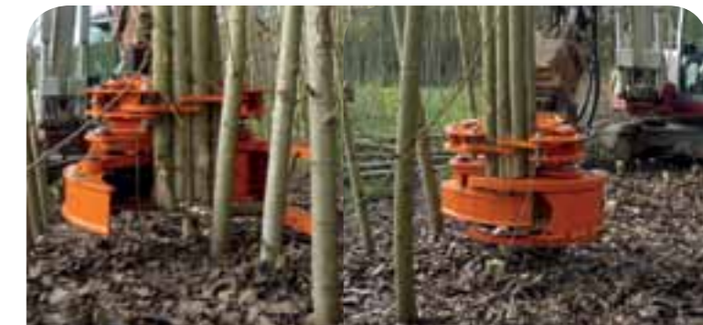
WOODCRACKER® CB 150: Montaje rígido (por ejemplo con excavadora)
